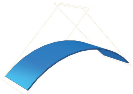
图 4 C 型结构的有限元模型 Fig.4 Finite model of C-shaped part
